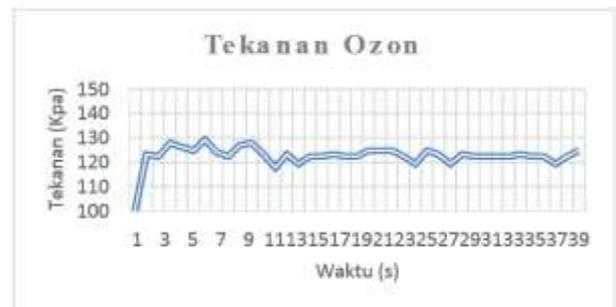
Gambar 18. Grafik pengujian tekanan ozon menggunakan kontroler fuzzy.
