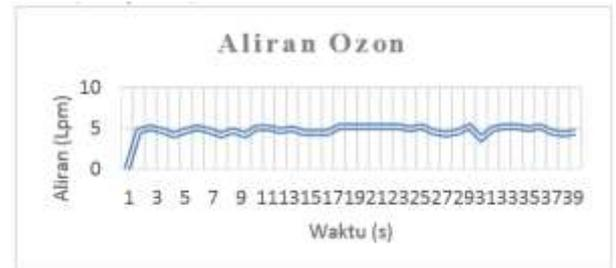
Gambar 17. Grafik pengujian aliran ozon menggunakan kontroler fuzzy.
