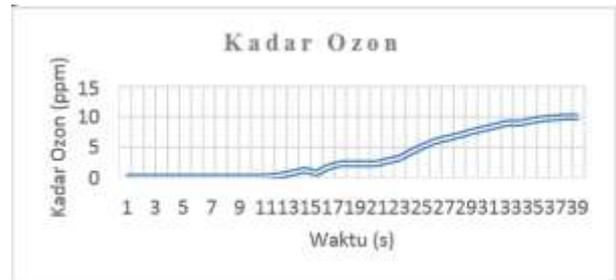
Gambar 16. Grafik pengujian kadar ozon menggunakan kontroler fuzzy.
