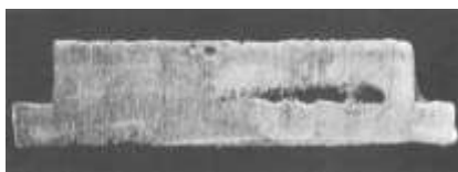
Gambar 3. Cacat penyusutan ( shrinkage ) [3]
