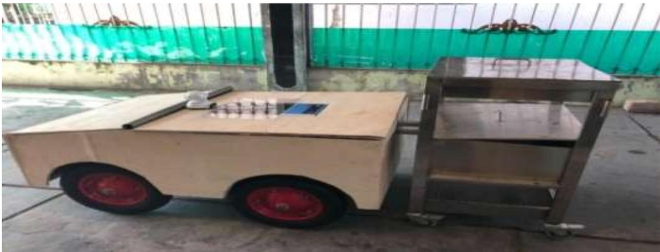
Gambar 7. Akhir mobile robot dengan beban troli 28kg.
