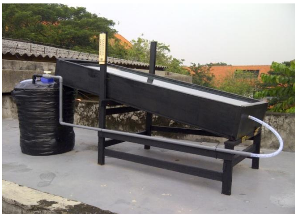
Gambar 1. Sistem Pemanas Air Tenaga Surya
