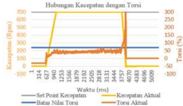
Gambar 12. Grafik hasil pengujian kecepatan terhadap torsi.
