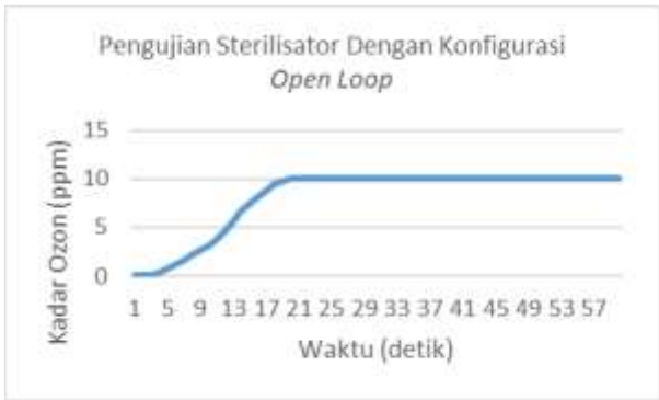
Gambar 16. Grafik pengujian sterilisator dengan konfigurasi open loop .
