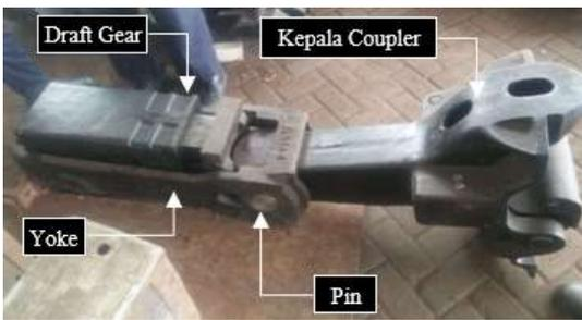
Gambar 1. Sistem perangkai pada lokomotif CC300.
