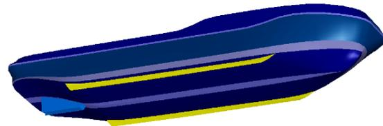
Gambar. 3. Ilustrasi penempatan *fins* pada area bawah lambung kapal
