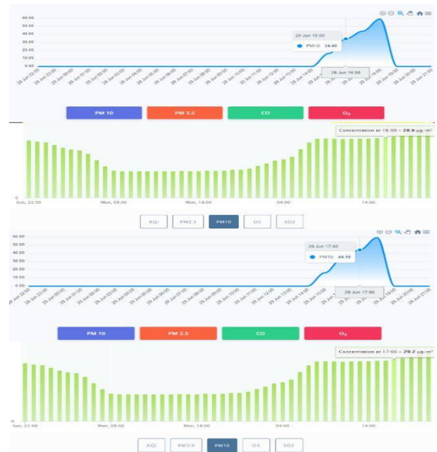
Gambar 13. Perbandingan kadar PM10 perangkat penelitian dengan perangkat pemerintah.
