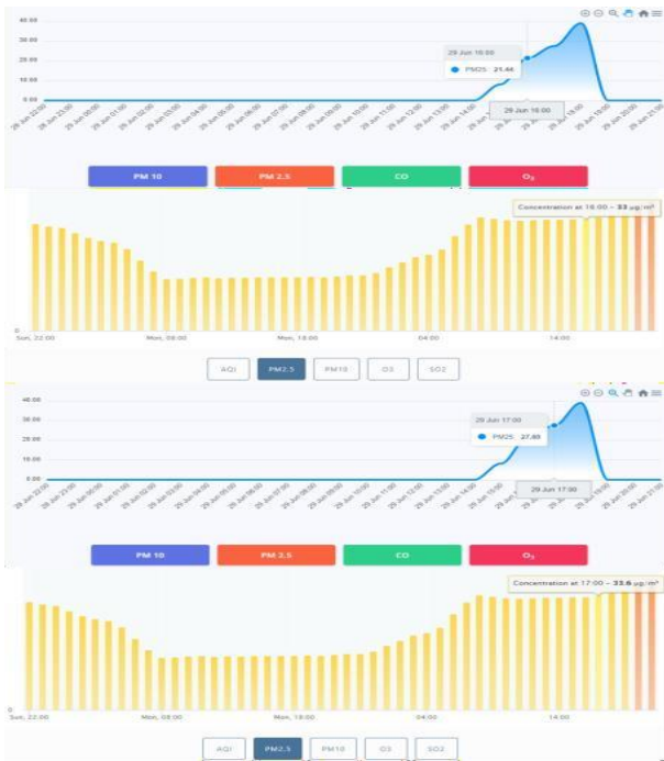
Gambar 12. Perbandingan kadar PM2.5 perangkat penelitian dengan perangkat pemerintah.
