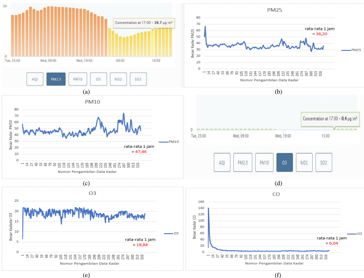
Gambar 11. Hasil pengujian kadar (a) PM2.5 perangkat (b) PM2.5 perangkat pemerintah (c) PM10 perangkat (d) PM10 perangkat pemerintah (e) O3 perangkat (f) O3 perangkat pemerintah (g) CO perangkat.
