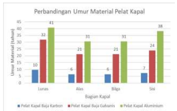
Gambar 5. Grafik Perbandingan Umur Material Pelat Kapal.
