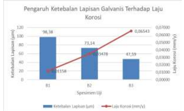
Gambar 4. Grafik Pengaruh Ketebalan Lapisan Galvanis Terhadap Laju Korosi.
