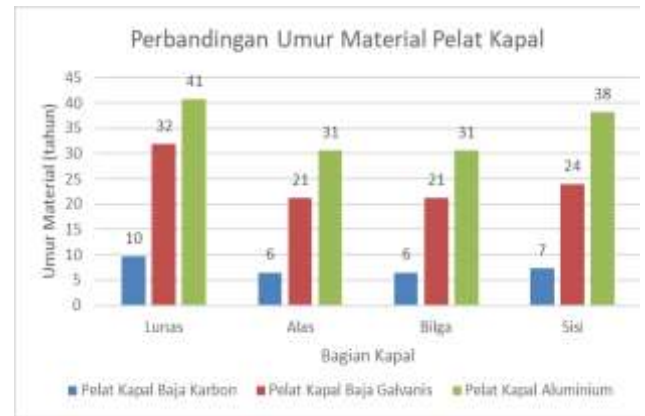
Gambar 6. Grafik Perbandingan Umur Material Pelat Kapal.
