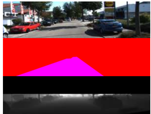
Gambar 3. Gambar RGB, ground truth, dan depth pada dataset KITTI berurutan dari atas ke bawah.
