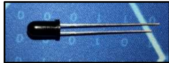
Gambar 5. Bentuk Fisik Photodioda.
