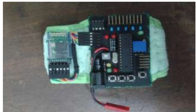
Gambar 7. Realisasi sistem minimum mikrokontroler.
