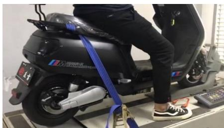
Gambar 3. Pengujian dynamometer *E-scooter* DJ.
