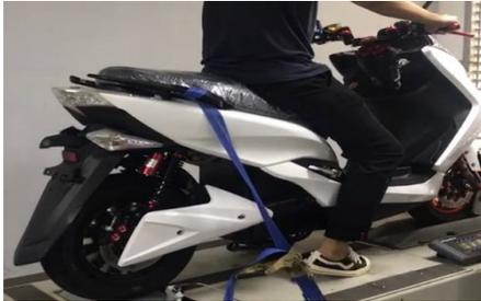
Gambar 2. Pengujian dynamometer *E-scooter* SH.
