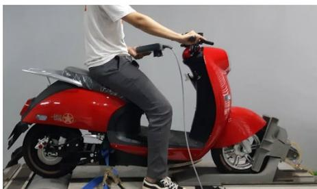
Gambar 4. Pengujian dynamometer *E-scooter* QS.
