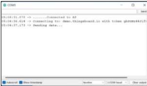
Gambar 12. Uji coba sambungan NodeMCU dengan ThingsBoard.
