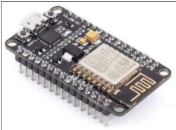
Gambar 1. Mikrokontroler ESP8266.
