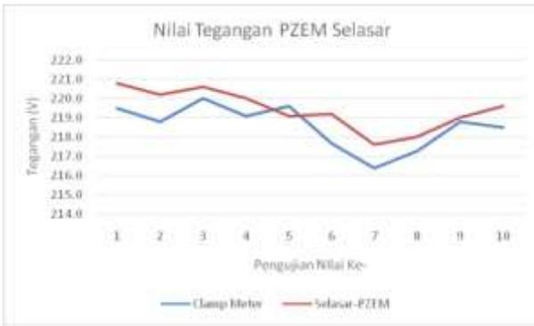
Gambar 7. Grafik nilai tegangan PZEM selasar dengan clamp meter.
