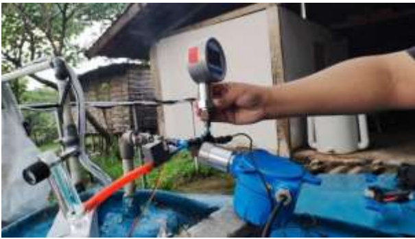
Gambar 2. Monitoring flowrate, kandungan gas metana, dan tekanan pada bioreaktor anaerob.
