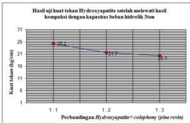
Gambar 2. Uji kuat tekan spesimen dengan beban 3 ton [2]
