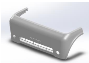
Gambar 3. Bumper depan rancangan baru
