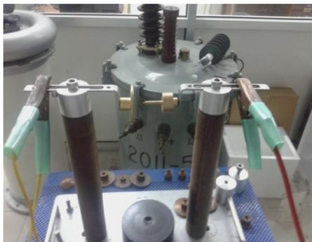
Gambar 8. Pengujian kombinasi elektrode jarum dan datar kuningan
