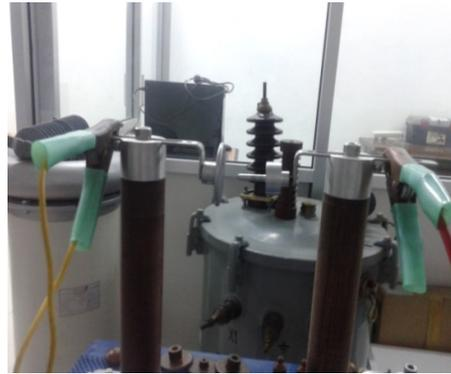
Gambar 10. Pengujian kombinasi elektrode tumpul dan datar aluminium
