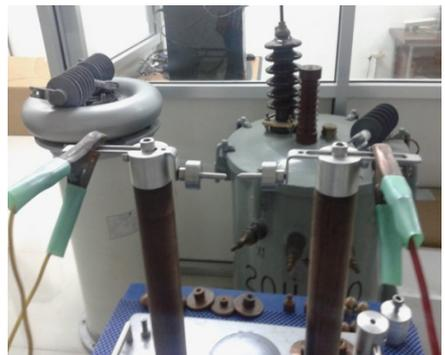
Gambar 9. Pengujian kombinasi elektrode jarum dan tumpul baja
