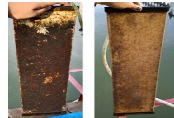
Gambar 10. Penampakan Membran Tanpa dan dengan Air Scouring Bertekanan Udara 0,6 Bar.
