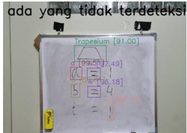
Gambar 21. Deteksi trapesium dan hasilnya pada pengambilan gambar 80cm.
