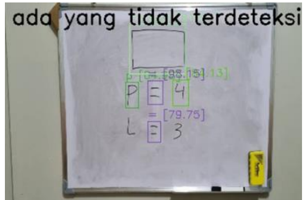
Gambar 20. Deteksi persegi panjang dan hasilnya pada pengambilan gambar 80cm.
