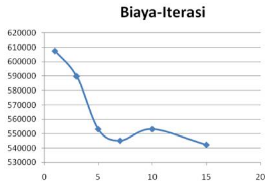
Gambar 5 Perbandingan jumlah iterasi terhadap biaya tipe 24 kL dengan jumlah 5 kendaraan
