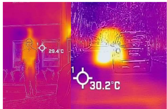
Gambar 5. Efek sinar matahari terhadap kamera termal.
