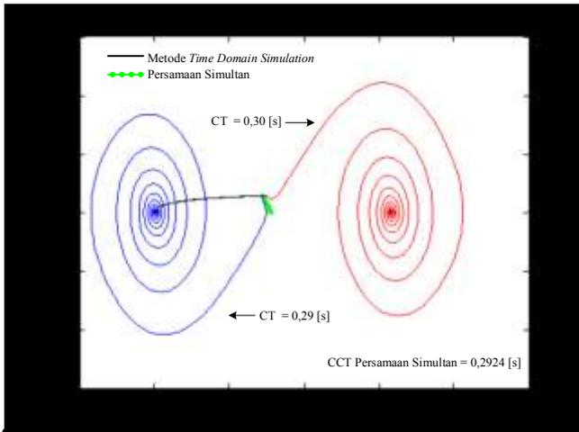
Gambar 9. Grafik karakteristik kecepatan sudut rotor  $\omega$  (rad/s) terhadap sudut rotor  $\delta$  (rad) di titik gangguan A pada sistem *smart grid* 3-generator 10-bus saat terhubung *infinite bus* dengan *damping*.
