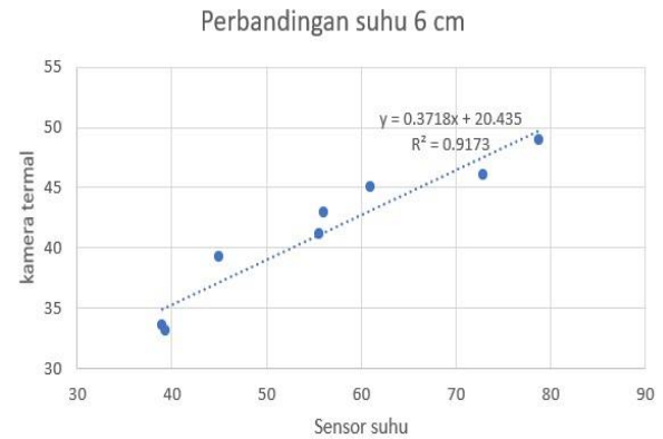
Gambar 11. Grafik suhu dimana sumbu x adalah nilai suhu dari sensor dan sumbu y dari kamera termal.
