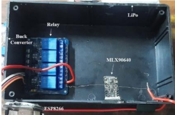
Gambar 8. Realisasi bentuk fisik sistem inspeksi kabel tampak atas.
