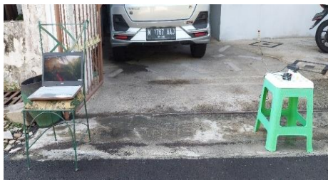
Gambar 3. Pengujian Kekuatan Sinyal Wifi terhadap Jarak.
