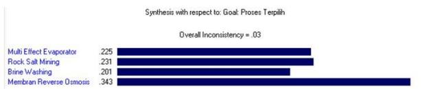
Gambar 8. Hasil seleksi proses pemurnian garam terpilih dengan menggunakan metode AHP.
