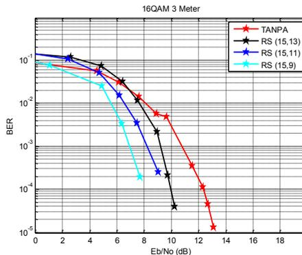
Gambar 4.13 Kinerja BER terhadap Eb/No pada modulasi 16-QAM
