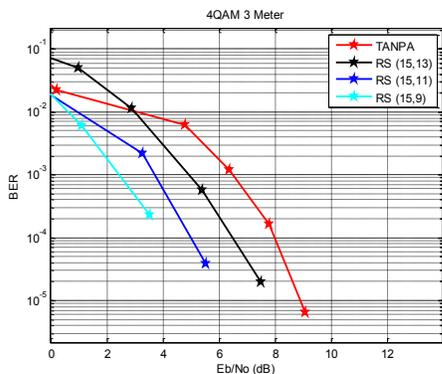
Gambar 4.11 Kinerja BER terhadap Eb/No pada modulasi 4-QAM
