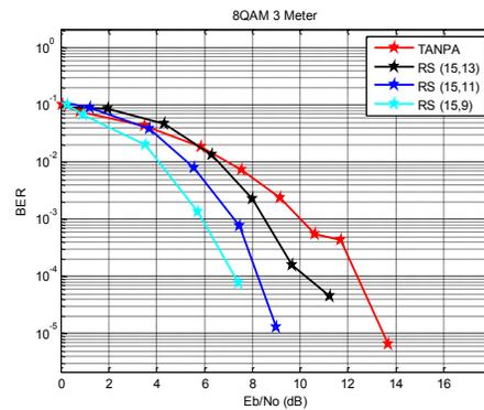
Gambar 4.12 Kinerja BER terhadap Eb/No modulasi 8-QAM
