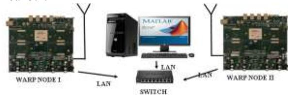
Gambar 3.2 Konfigurasi Sistem Komunikasi dengan WARP
