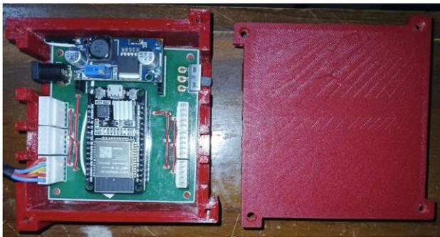
Gambar 17. Sistem kontrol kunci loker (mikrokontroler).
