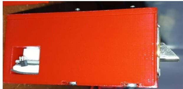
Gambar 19. Sistem pengunci solenoid dan hall sensor.
