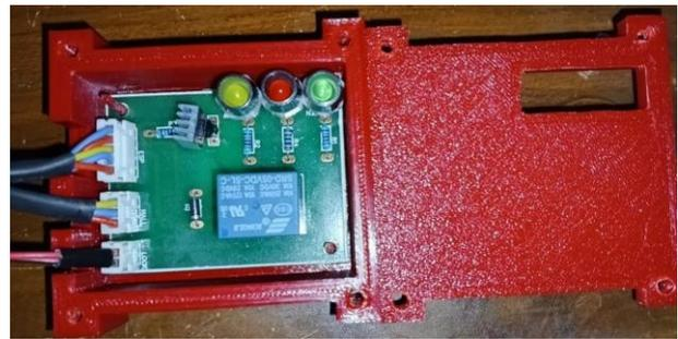
Gambar 18. Sistem kontrol kunci loker (relai).
